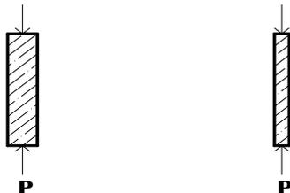
Gambar 2.3. Kolom Pendek dengan Keruntuhan Berdasarkan Jenis dan Kekuatan Materialnya
